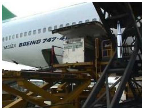
Slika 5.11 Tehnika utovara kontejnera u teretni avion
